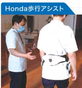
股関節の動きをモーター内蔵の角度センサーが検知し、制御PCがモーターを駆動します。
